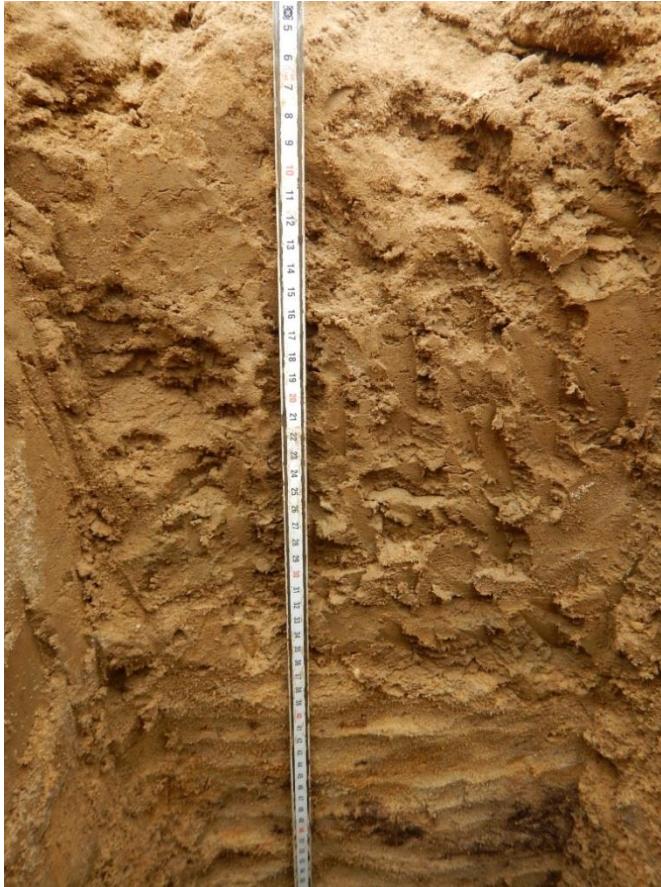
Opvallend rode grond (ijzer). Kleiig zand profiel. Zandlaag vanaf 37 cm. Roestvlekken en organisch materiaal.
