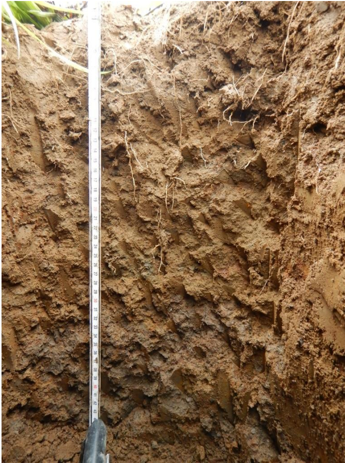
Profiel met storende blauwe kleilaag op 35 cm diepte
