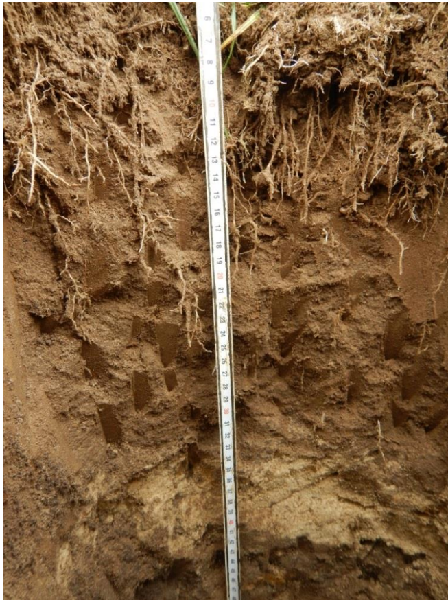
Profiel met zandlaag op 35 cm diepte.
